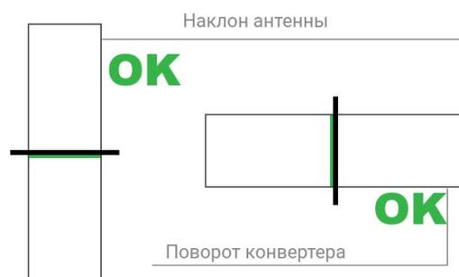
Для завершения установки антенны останется только произвести поворот антенны вправо-влево до достижения максимального уровня сигнала, и убедиться, что пойман необходимый спутник. Если спутник отличается от искомого, то повторно производится корректировка антенны при помощи смещения вправо-влево до нахождения нужного спутника.
